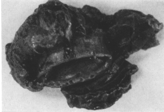
Abb. 3. Dasselbe Geschöß von der Basis aus gesehen. Es fällt die seitliche Abflachung an der Basis auf, da das Geschöß unter einem Winkel von etwa 25^\circ aufschlug
